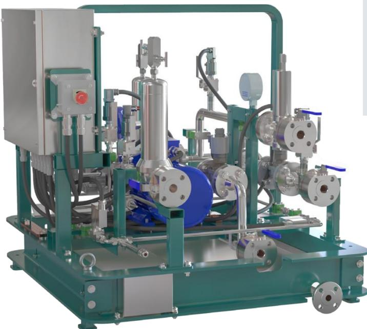
独立控制面板监控参数并根据发动机需求管理燃料供应。可编程逻辑控制器 可集成至主控制系统，并编程以满足包括燃料供应映射在内的多种任务。变频驱动装置通过50 Hz的三相电动机实现恒速燃料供应，且可选调节速度范围为0 Hz至320 Hz。电磁阀、传感器及变送器均为24V直流电。
